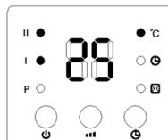
Se la temperatura ambiente è inferiore al valore impostato sul display, rimane in stand-by.
