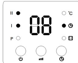
Schaltet das Gerät ein wenn es auf stand-by Modus ist und jeden Druck erhöht der Timer die Laufzeit von einer Stunde (max 1Stunden) wenn die Zeit auf dem Timer fertig ist geht das Gerät an. Auf dem Display leuchtet ein LED neben den
