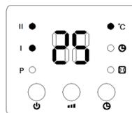
Se la temperatura ambiente è inferiore al valore impostato sul display, rimane in stand-by.
