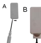
remplacer la batterie (en respectant la polarité) et refermer le porte-batterie. Pour de longues périodes d'inactivité de la télécommande, enlever la batterie.
