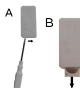
sustituya la batería (según la polaridad correcta) y cierre el soporte de baterías. En caso de periodos de inactividad prolongados del mando a distancia quite la batería.
