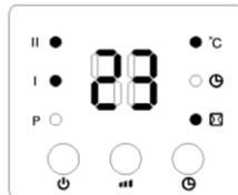
Si la temperatura se reduce por debajo del valor configurado en poco tiempo, el programa apaga el aparato y luego lo pone en espera: para volverlo a activar pulse
